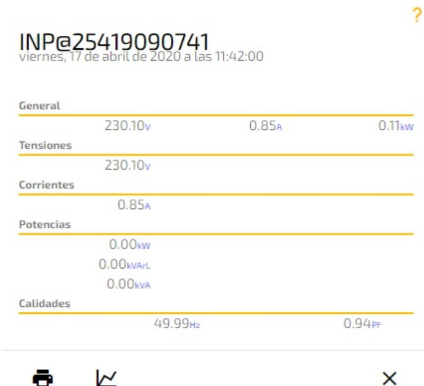
En el podemos visualizar la tensión, la intensidad y la potencia tanto por fase como la total. Además nos muestra la potencia activa reactiva y aparente así como la frecuencia y el factor de potencia.
